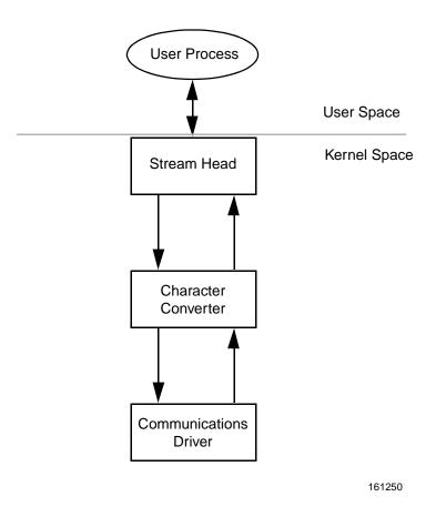
Figure 3-6. Case Converter Module
